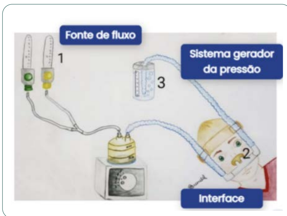
Figura 1: Circuito do CPAP bolhas
